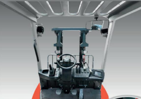
El mástil de visión amplia optimiza el área ciega de la visión de operación y garantiza una operación cómoda y segura;
