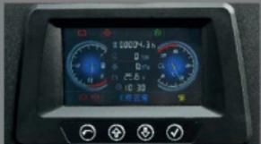
Pantalla LCD a color completa El instrumento CAN bus monitorea completamente el estado del camión; muestra información sobre fallas del motor y del camión en tiempo real y brinda recordatorios humanizados;
