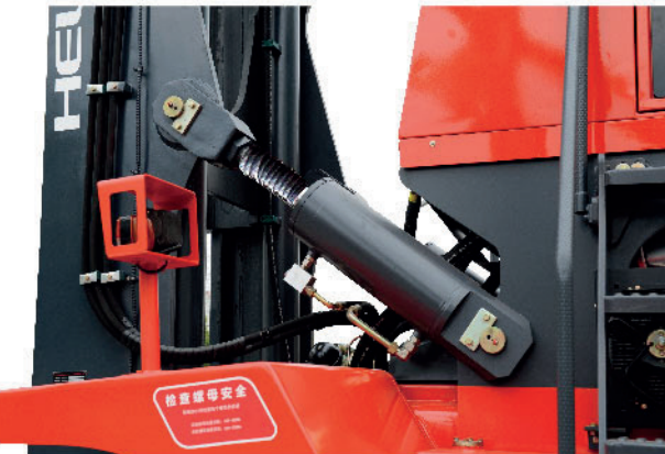
■ Manga de protección del cilindro de aceite (opcional): se utiliza para proteger el cilindro dañado por materias extrañas.
