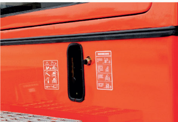
■ Botón basculante eléctrico con alto grado de resistencia al polvo y al agua: grado de protección: IP67
